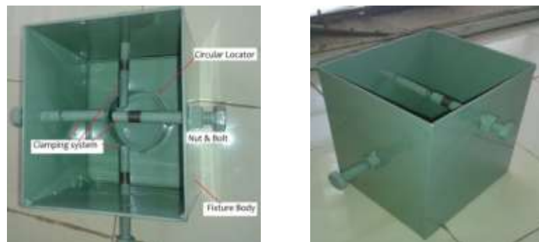
Fig.5: Actual Photos of Box Type Femur Bone Fixture
